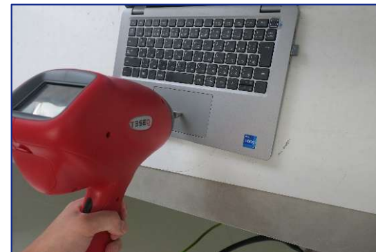
接触放電セットアップ写真
