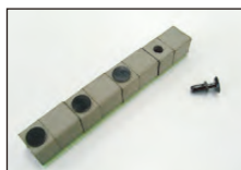
穴加工 + リベット追加加工 Punching + Rivet processing
