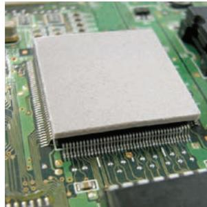
「電子機器の小型化・高速化」によって問題となっている「熱」を効果的に伝熱及び断熱を行う製品群です。
