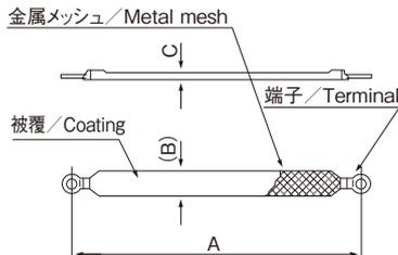
■ M3ねじ取付タイプ / M3 screw assembly type 単位 / Unit: mm
