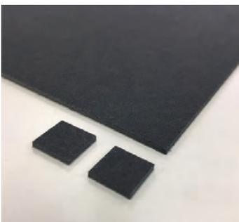
薄型・軽量のGHz用ピンポイント型電波吸収体
