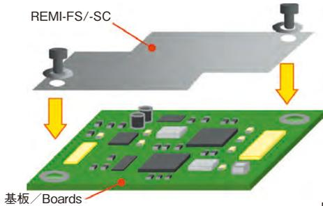
例) 金属膜面を利用し、小型基板をシールド
